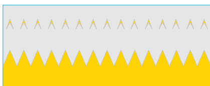
La cuchilla ha saltado o la tensión de la bobina es demasiado alta.
