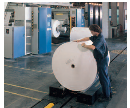
Preparación fuera del desbobinador.
