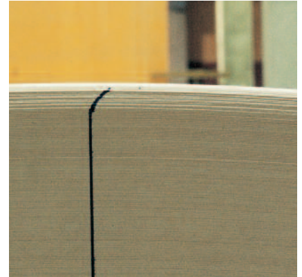
Expansión dinámica de la bobina después de sacar su envoltorio.
