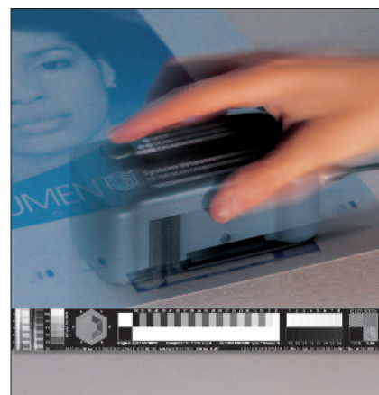
Misurazione della lastra con l'uso di un lettore di lastre a scansione con apposita striscia di controllo digitale per lastre. Per la misurazione delle lastre sono ampiamente usati anche i lettori delle lastre (come X-rite, ccDOT, Techkon DMS). Foto: System Brunner.
